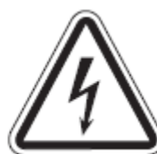
Úraz elektrickým prúdom
